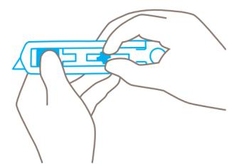
Pour modifier le débord de lame, **desserrer la vis de blocage** (d'un tour). Plus la vis se situe à gauche, plus le débord est grand.
