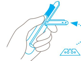
À l'aide de l'index, **déployer lentement vers le bas** le support de lame, de l'autre main, retirer et retourner ou changer la lame.
