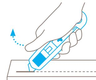
Retirez le **pouce du curseur** pour permettre la rétraction semi-automatique de la lame.
