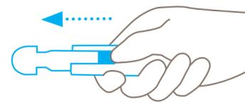
En prenant appui sur le curseur, **pousser** l'insert en plastique hors du manche. **Ne pas** simultanément tirer sur l'insert et maintenir le curseur.
