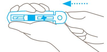
Placer la lame **exactement sur les ergots**, relever le support de lame. Réintroduire l'insert plastique dans le manche. **ATTENTION** : Ne pas placer la main dans la zone de sortie de la lame !
