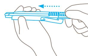
Réintroduisez le curseur et la lame **dans le manche** et rabattez l'extrémité du manche vers le haut. Testez le curseur en l'actionnant, vérifiez que la rétraction de la lame fonctionne parfaitement puis coupez.
