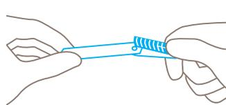
Soulevez le curseur, retirez et changez la lame. La perforation de la lame doit être **placée exactement sur l'ergot**. Les gauchers tournent la lame de 180°. Les deux aimants vont maintenir additionnellement la lame.
