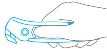
Pour une prise en main optimale, placez votre pouce sur la **surface rainurée**. Le soft-grip offre encore plus de résistance au glissement.
